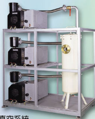
真空系統 Vacuum system
